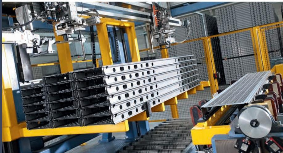
鋼帯を偏心プレスで打ち抜き、金型で所定の長さにカットします。これに続いてプロファイリングシステムがあります。このシステム内では基板が約 15 m の区間上でボックスプロファイル通りに成形されます。ほぼ完成した鋼床は自動的に積み上げられます。その後の溶接システムで、最終的にキャップがボックスプロファイル内の台架の爪と溶接されます。
