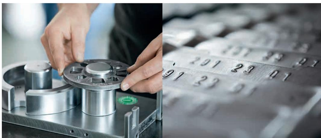
同様に、各製造工程にどれだけ厳格な品質管理があるかは自明なので、全ての部品のマーキングと文書化が必須です。そのため、例えば各 Layher 製床板には製造プロセスの最後で、機械に関する情報、製造年月日、および様々な製造パラメータを示すエンボス加工が施されます。
