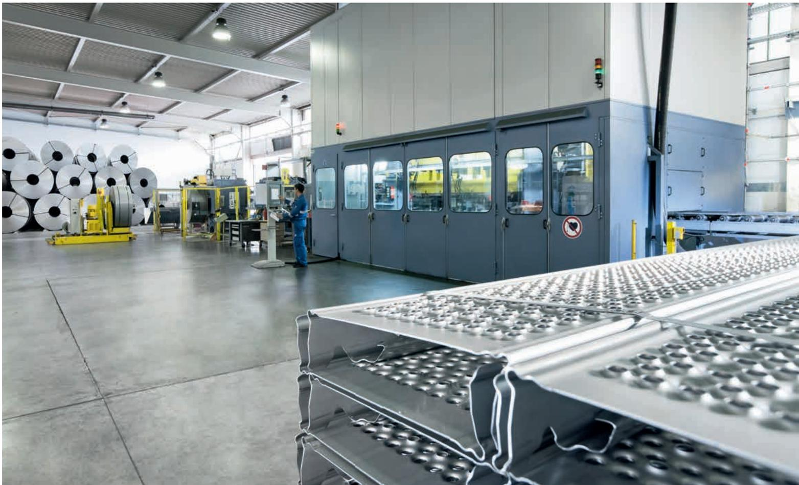
Layher製鋼床版は最大重量 11 トン、長さ 1,7km の鋼帯で製造されています。いわゆるエンドレスコイルはクレーンとローダーワゴンとともにリール内に配置されます。そのリールによって鋼帯から整流装置経由で 650 トンの偏心荷重が供給されます。
