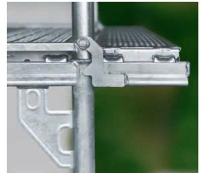
独創的なソリューション:迅速な足場拡張のための Layher の差込式腕木。従来の腕木はハーフカップリングとボルトで固定して繋がらなければなりませんでしたが、差込式腕木は最初からある差込穴に差し込むだけで取り付けられます。
